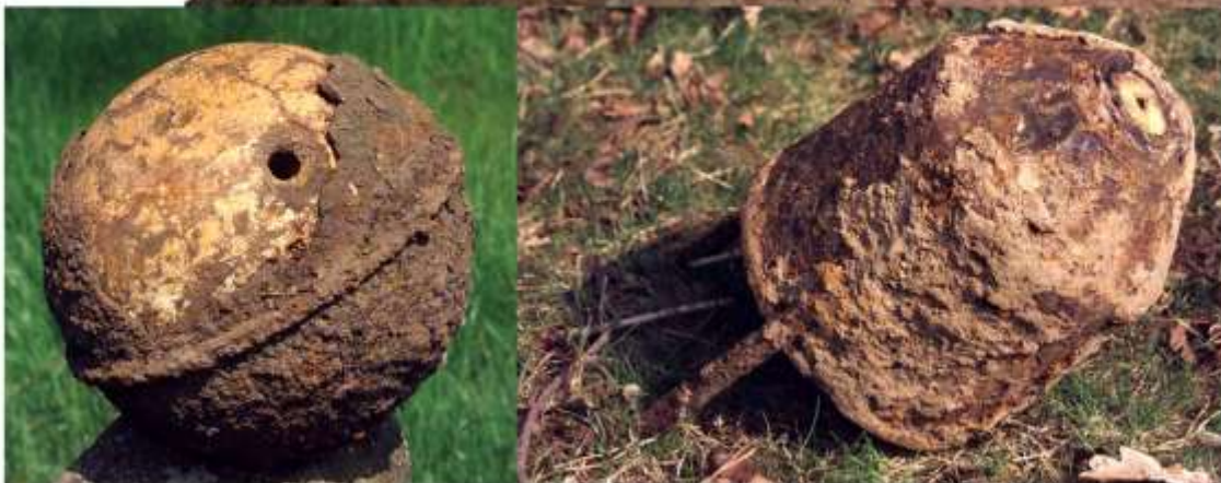
L'enveloppe en tôle de cette charge explosive sphérique allemande de 3 kg a été éliminée par la corrosion, laissant à nu le puits d'amorçage avec son relais, tout comme pour la charge creuse américaine de démolition présentée à droite.
