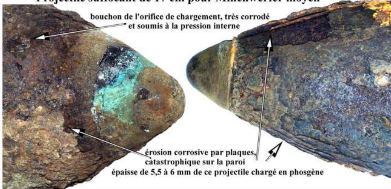
Projectile suffocant de 17 cm pour Minenwerfer moyen
